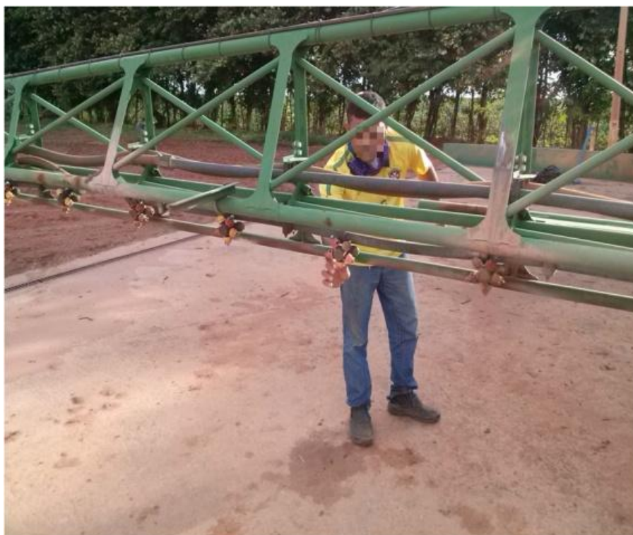
Figura 37: Operador fazendo a manutenção do pulverizador sem EPIs.
