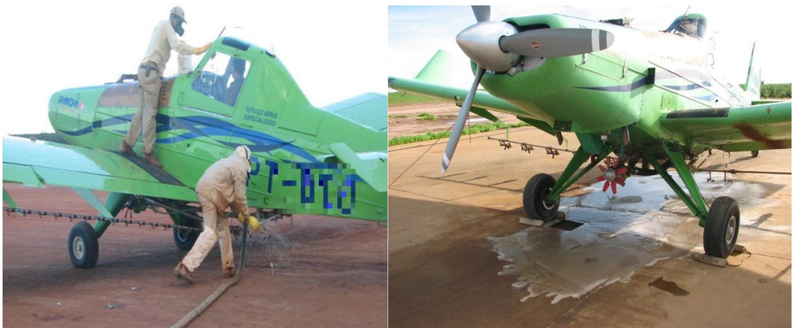
Figura 35: Falhas no uso de EPIs na manipulação dos agrotóxicos e vazamentos.
