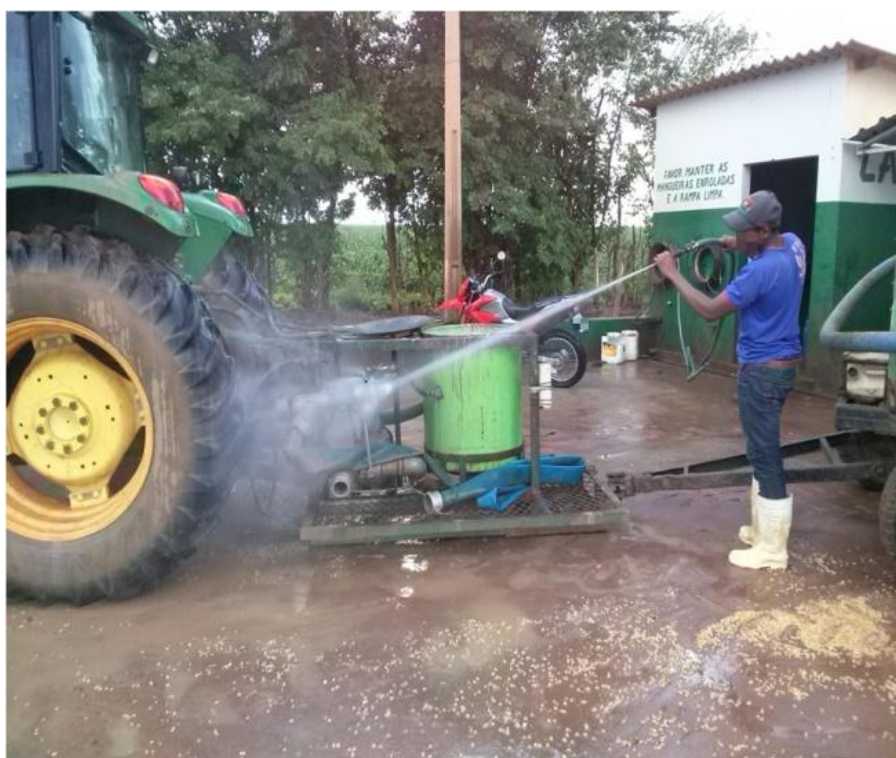
Figura 38: Limpeza do equipamento contaminado sem EPIs e descuido quanto ao destino da água.
